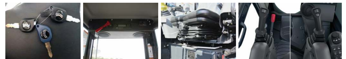
새로운 타입의 엔진 시동키 - 엔진 시동시 사용자 비밀번호 설정(수정) 가능
