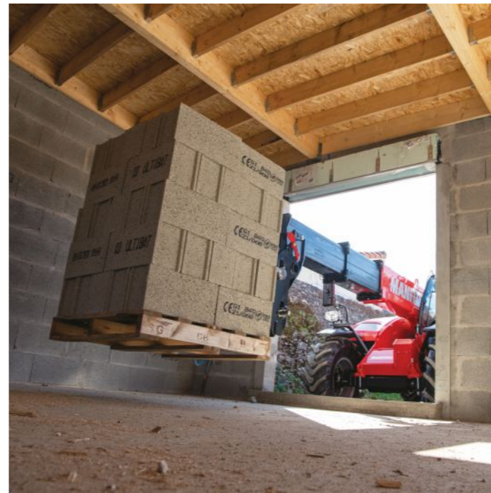
전방으로 붐을 뺄 수 있어 실내 진입 없이 높이 제약없는 넓은 작업 범위
