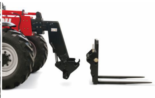
1분 이내 탈부착이 가능한 반자동 링크 다양한 작업 장치 장착 가능
