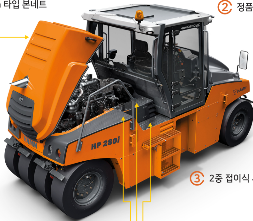
④ 엔진룸 주변 3곳의 여유있는 거주공간 확보로 누구나 쉽고 편한 유지보수 가능
