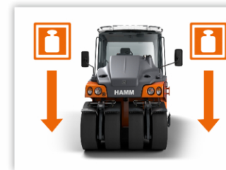
추가 물탱크와 Steel Ballest로 완벽한 무게중심과 하중분포 실현
